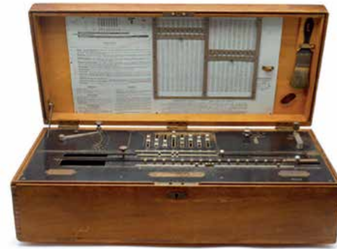
Millionär-rekenmachine, gebruikt voor de uitvoerige berekeningen die voorafgingen aan bouw van de Afsluitdijk (Boerhaave Museum)
